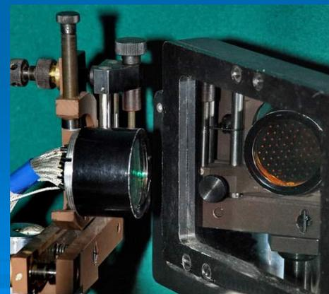
Корректор с апертурой 40 мм в оптической схеме для исправления aberrаций волнового фронта
