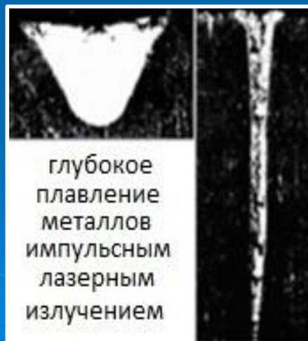
Впервые предложена, построена и развита физическая модель процесса глубокого плавления металлов импульсным лазерным излучением миллисекундного диапазона длительности
