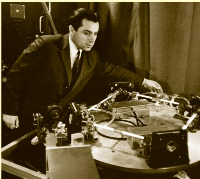
Е.П. Маркин настраивает кольцевой He-Ne лазер – прообраз гироскопа
