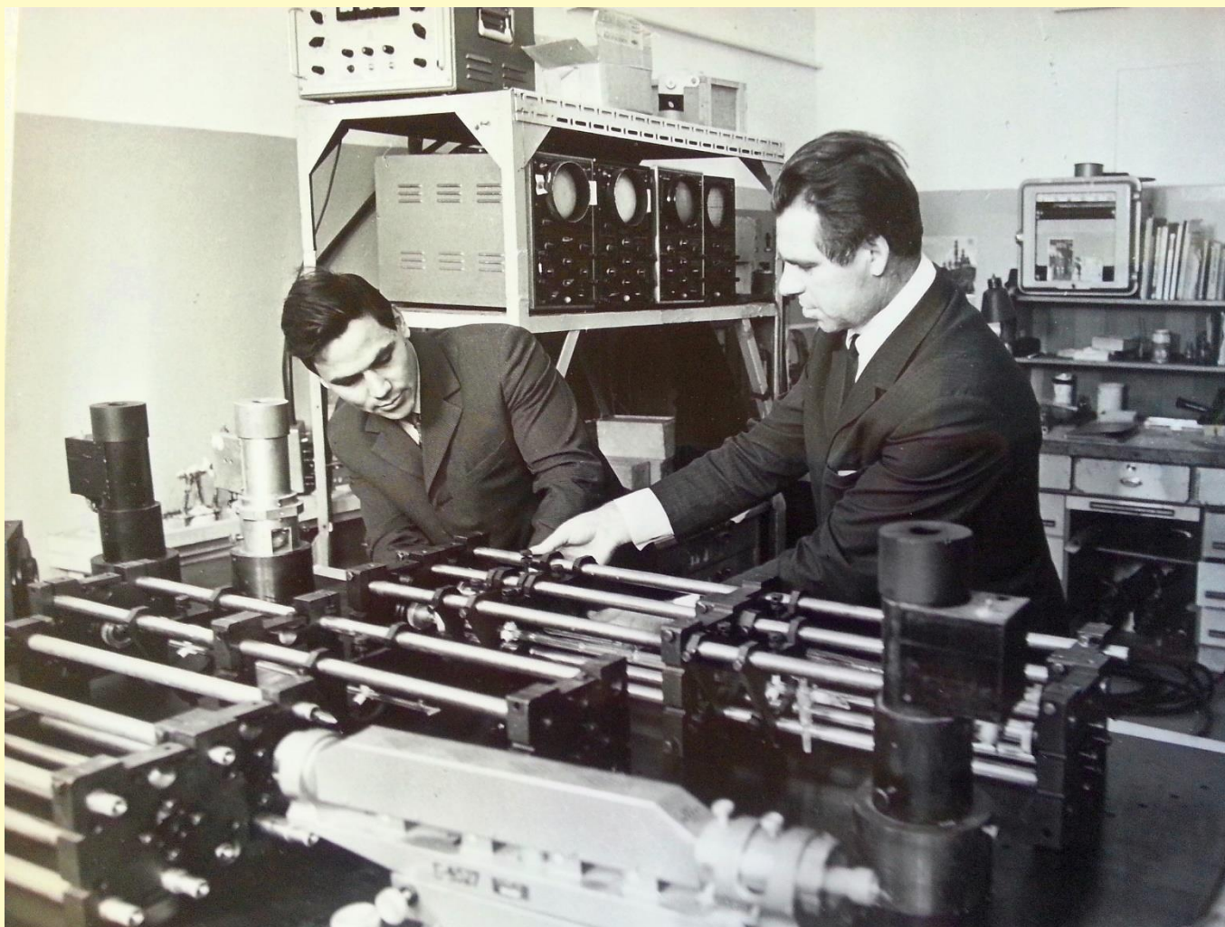
В.В. Никитин и М.А. Губин (слева) настраивают He-Ne лазер ( \lambda \sim 3,39 мкм) с поглощающей метановой ячейкой
