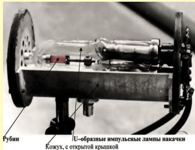
Первый рубиновый лазер, созданный в ФИАН
