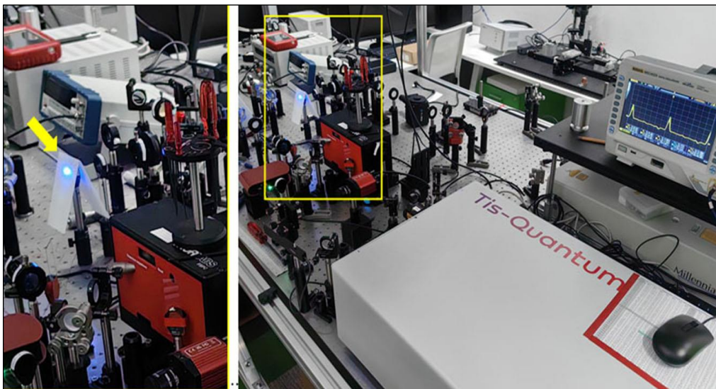
Рис.5 Генерация второй гармоники фемтосекундными импульсами. Пятно второй гармоники указано на увеличенном фрагменте изображения слева стрелкой.
