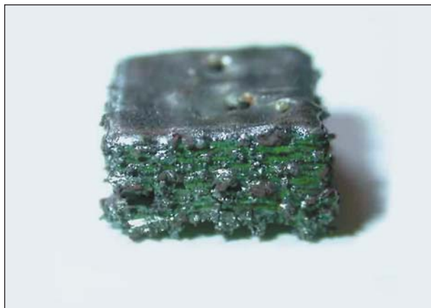
Пористое объемное изделие, спеченное из порошка гексаферрита стронция ( \text{SrFe}_{12}\text{O}_{19} ).
