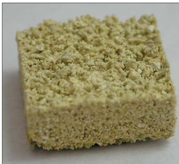
Объемное изделие, синтезированное из смеси готовой керамики на основе твердого раствора цирконата-титаната свинца. Наполнителем служит \text{SiO}_2 .
