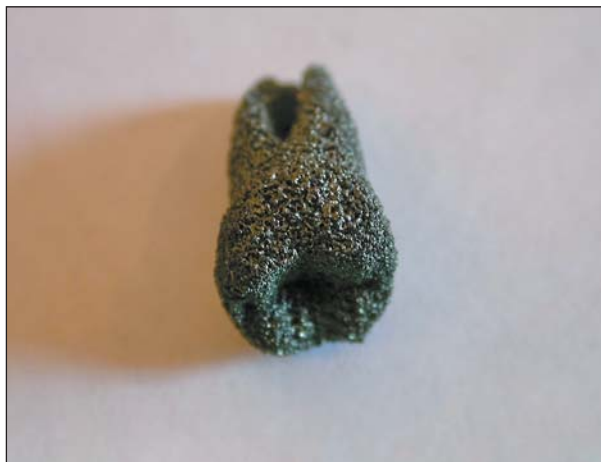
Образцы функциональных объемных изделий из никелида титана: штифт для протезирования зуба (слева) и коренной зуб.
