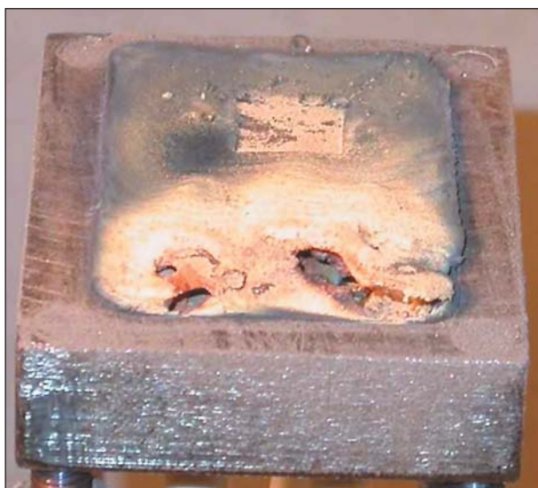
Внешний вид образца титана, полученного методом СЛС на воздухе при отсутствии контроля. В центре отчетливо виден квадрат, который предназначался к обработке.
