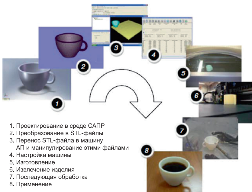
Рис. 1.2. Общее представление процесса аддитивного производства, состоящего из восьми стадий при изготовлении изделия
